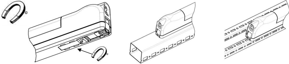
**Magnet-Fixierung + Schrauben mit variablem Lochabstand von 455 bis 475 mm**
