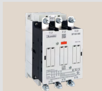
3-polige Schütze Ith (AC1 bei 40°C) 16...1600A Ie (AC3 440V) 6...630A Leistung (AC3 400V) 22...335kW
