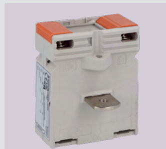
Wickelstromwandler Primärstrom 5...30A Sekundärstrom 5A/1A Schraubklemmen
