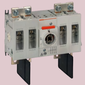
DC-Trennschalter der Serie GD Bemessungsisolationsspannung UI. 1500V (Verschmutzungsgrad 2) Lebensdauer: 10.000 mechanische Schaltspiele
