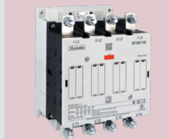
Leistungsschütze mit Hilfsversorgungsspannung AC/DC, 3- oder 4-polige Ausführung und Spiegelkontakte nach EN60947-4-1.
