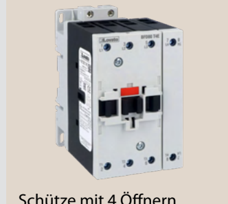
Schütze mit 4 Öffnern oder für PV-Anlagen mit 4 Schließern Betriebsstrom bis 125A (DC1 bei 55°C) 4NO in Reihe geschaltet
