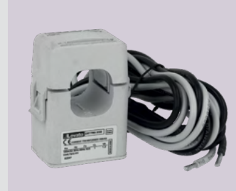
Vorverkabelte Umbaustromwandler Primärstrom 100...6000A Sekundärstrom 5A Kompakte Abmessungen; Kabellänge 2m
