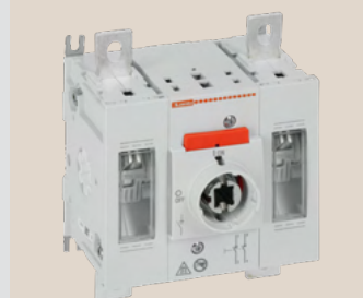
Serie GD Bis 850A 1000VDC (DC21B) und bis 315A 1500VDC (DCPV1) PV-Anwendungen; direkte Betätigung und Türverriegelung
