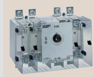
Serie GE 50A bis 1600A (AC21A)Trennschalter für direkte Betätigung und Türverriegelung 3-polige und 4-polige auch motorisiert.
