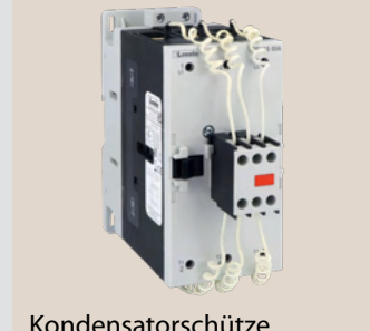
Kondensatorschütze Begrenzungswiderstände inbegriffen IEC Leistungen (400V) 7,5...100kvar AC-Spulen
